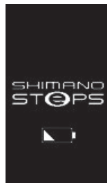
Nivel de la batería demasiado bajo
