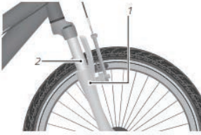
1.Süspansiyon alt bacakları 2.Süspansiyon dikey (stanchion) borusu
